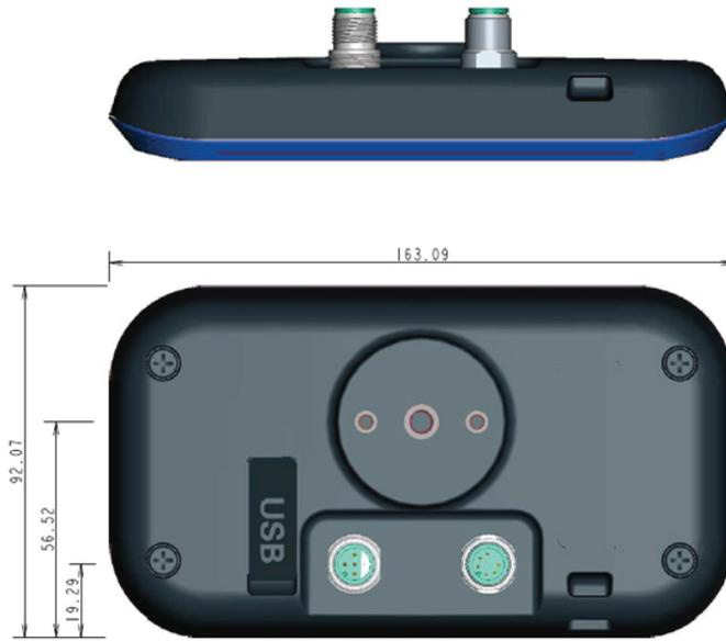
Figure 2 : Dimensions de l'interface de batterie
